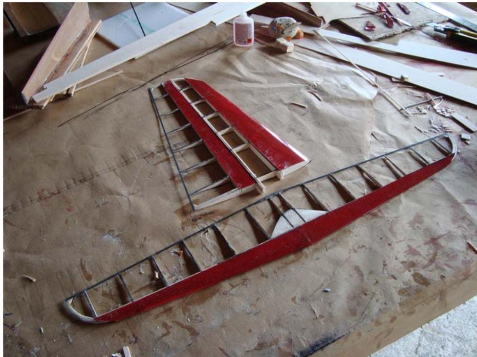
*Un stabilisateur et une dérive de course pour seulement 45gr l'ensemble. Même avec un stabilisateur en V construit dans un moule on ne fait pas mieux (on descend en général difficilement en dessous de 75gr en version non démontable).*
