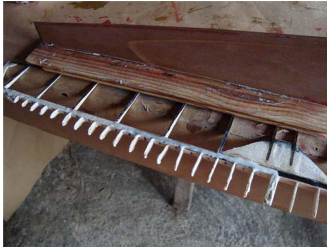
***Résine + micro-ballon déposé sur chaque nervure. Ce que vous voyez représente le maximum que l'on doit mettre. Il y en a au moins 2 fois trop !***
