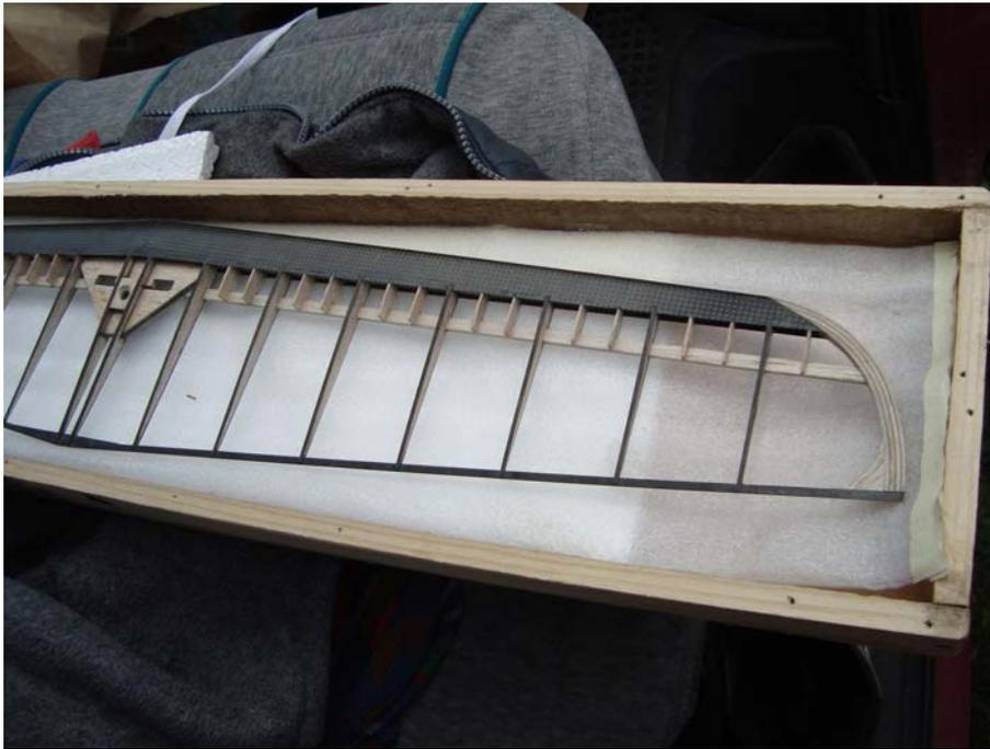
*Stabilisateur selon G. Noque. Le treillis en balsa apparent n'est pas encore enlevé. A ce stade, le stabilisateur fait 18gr. Rigidité en flexion et torsion impressionnante compte tenu du poids de cet élément de 66 cm d'envergure.*
