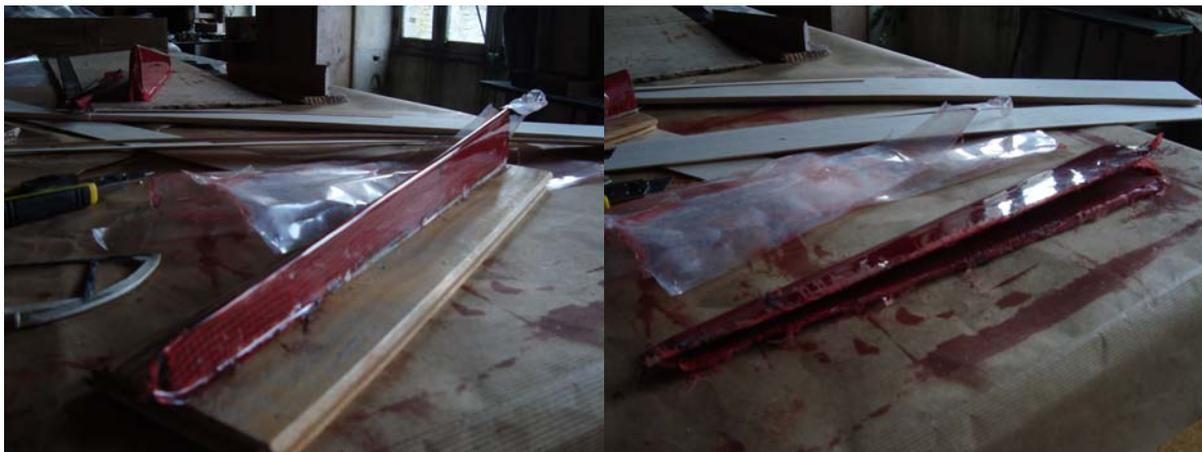
*Sortie des moules du sac et démoulage. Pour un premier essai, c'est pas mal du tout. Pas de poussière, une surface glacée et régulière.*
