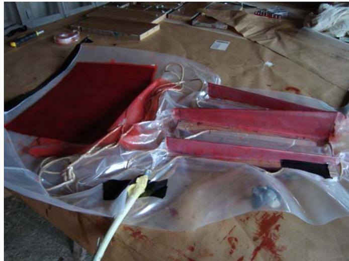
*Mise sous vide des D-box pour un stabilisateur et une dérive. Une plaque a été rajoutée dans le sac afin de faire les renforts du volet de dérive (mini D-box). Il faut que le sac plaque bien le composite sur son moule.*
