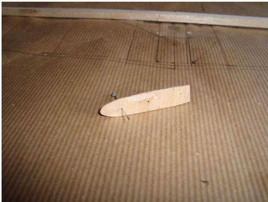
*Gabarit d'emplanture et une épingle pour réaliser les nervures.*
